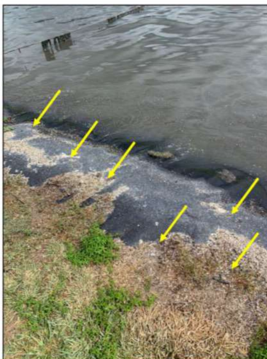
Foto 05: Fragmentos de geomembrana e manta geotêxtil não-tecido (Bidim) retiradas da lagoa (25/01/2022).
