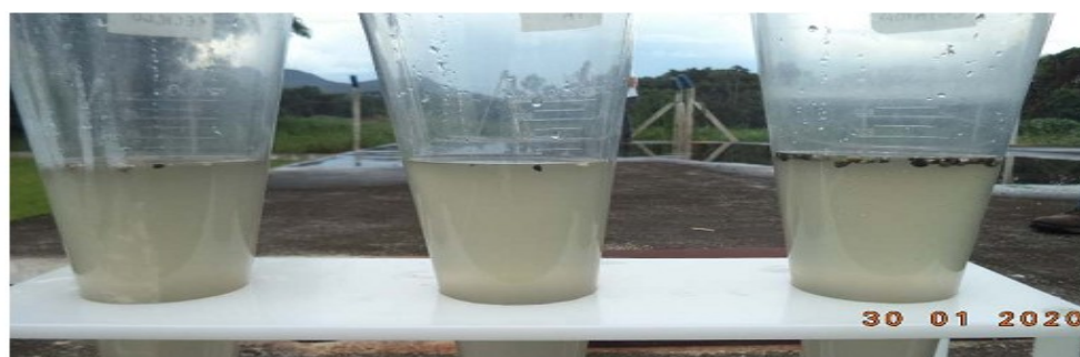
Foto 05 - Amostras de efluente tratado apontando existência de materiais flutuantes
